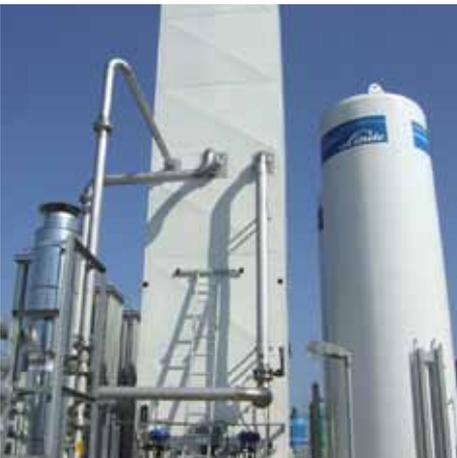
composta dal 60% di azoto e 40% di ossigeno sul fondo della colonna e azoto quasi puro in testa (punto più alto). La miscela è poi mandata in una successiva colonna a pressione atmosferica, in cui si recupera azoto purissimo in testa e ossigeno liquido al 95% al fondo. Il rimanente 5% è composto principalmente da argon.
